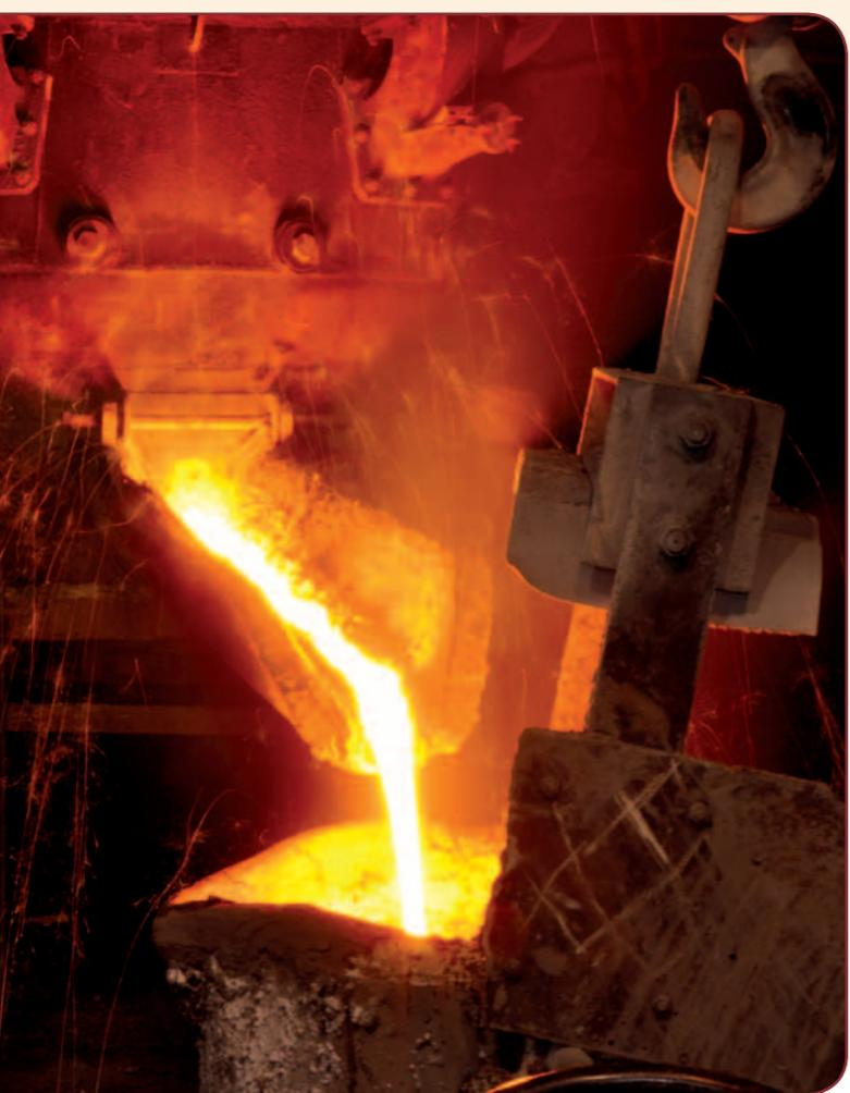
Topienie żeliwa realizujemy w systemie DUPLEX za pomocą dwóch żeliwiaków z zimnym dmuchem o średnicy 900mm oraz dwóch pieców indukcyjnych sieciowej częstotliwości o pojemności 3Mg.
