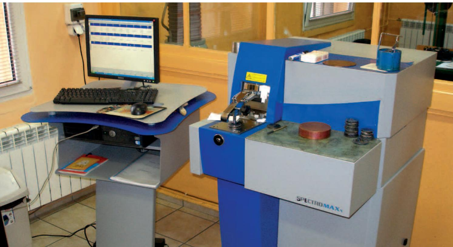
Posiadamy Laboratorium wyposażone w najnowsze urządzenia kontrolujące skład chemiczny płynnego metalu oraz parametry masy formierskiej. Przeprowadzamy badania międzyoperacyjne i końcowe produkowanych odlewów.
