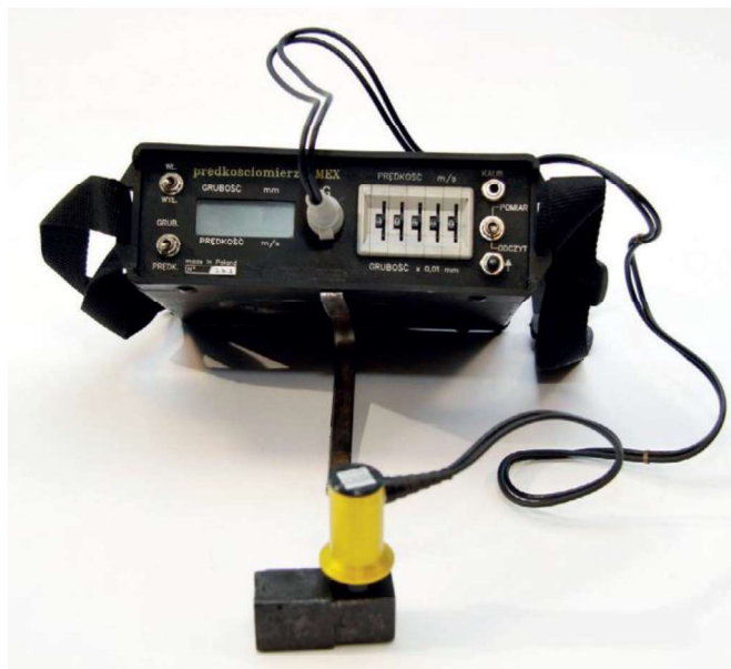
Rys. 5.6. Stanowiska do kontroli stopnia sferoidyzacji żeliwa, z widoczną próbką, głowicą i ultradźwiękowym próbnikiem materiałów.
