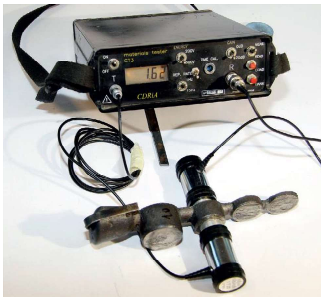
Rys. 5.7. Kontrola wrażliwości żeliwa na szybkość stygnięcia metodą ultradźwiękową.
