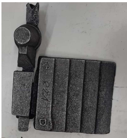
Rys. 4.14. Odlew próby schodkowej do oceny wrażliwości na szybkość stygnięcia (wytop R21)
