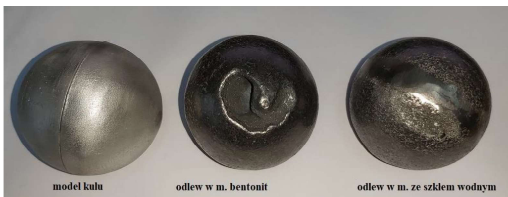
Rys. 4.9. Wygląd odlewów kul wykonywanych w teście oceny skłonności żeliwa sferoidalnego ferrytycznego do tworzenia jam skurczowych: z lewej model kuli, kula z masy klasycznej, z prawej – kula uzyskana w masie ze szkłem wodnym.
