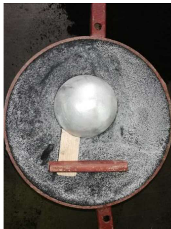
Rys. 4.6. Wykonywanie formy dla oceny skłonności żeliwa do tworzenia jam skurczowych, metoda z zastosowaniem modelu w kształcie kuli ( d = 80\text{mm} )
