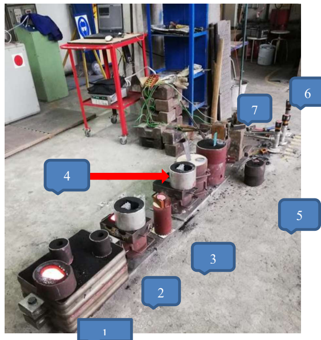
Rys. 4.7. Zestaw prób wykonywanych podczas wytopów doświadczalnych w odlewni Wydziału Odlewnictwa AGH: 1 – forma odlewu doświadczalnego, 2 – forma próby Y, 3 – próba schodkowa (wrażliwość na szybkość stygnięcia), 4 – formy do badań skłonności do tworzenia jam skurczowych, 5 – próby klinowe – zdolność do grafityzacji, 6 – analiza termiczna, 7 – próbki do badań spektrometrycznych.
