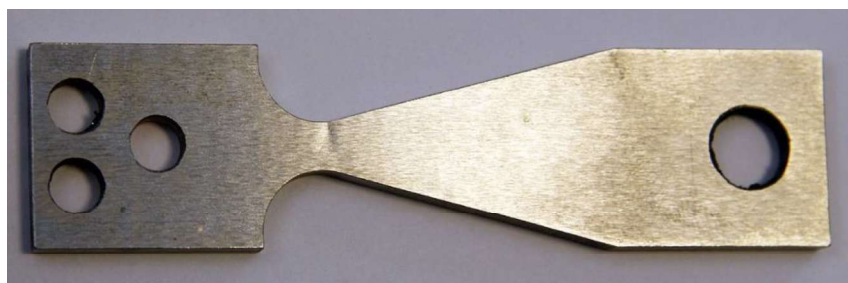
Rys. 4.28. Wygląd próbki do badań niskocyklowego zmęczenia w warunkach jednostronnego zginania
