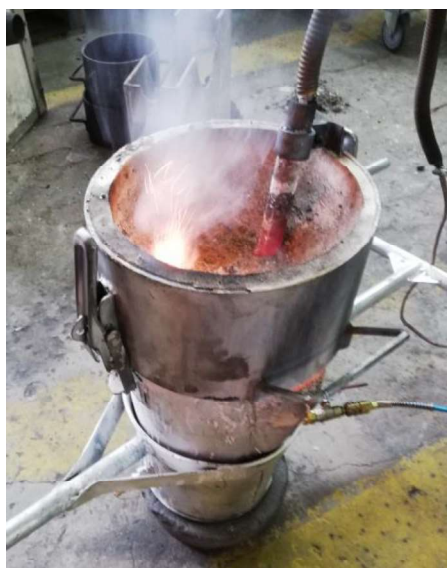
Rys. 3.6. Kadzi ze szczelną pokrywą z termoparą w pokrywie w tulei grafitowej – pomiar spadków temperatury podczas rafinacji.
