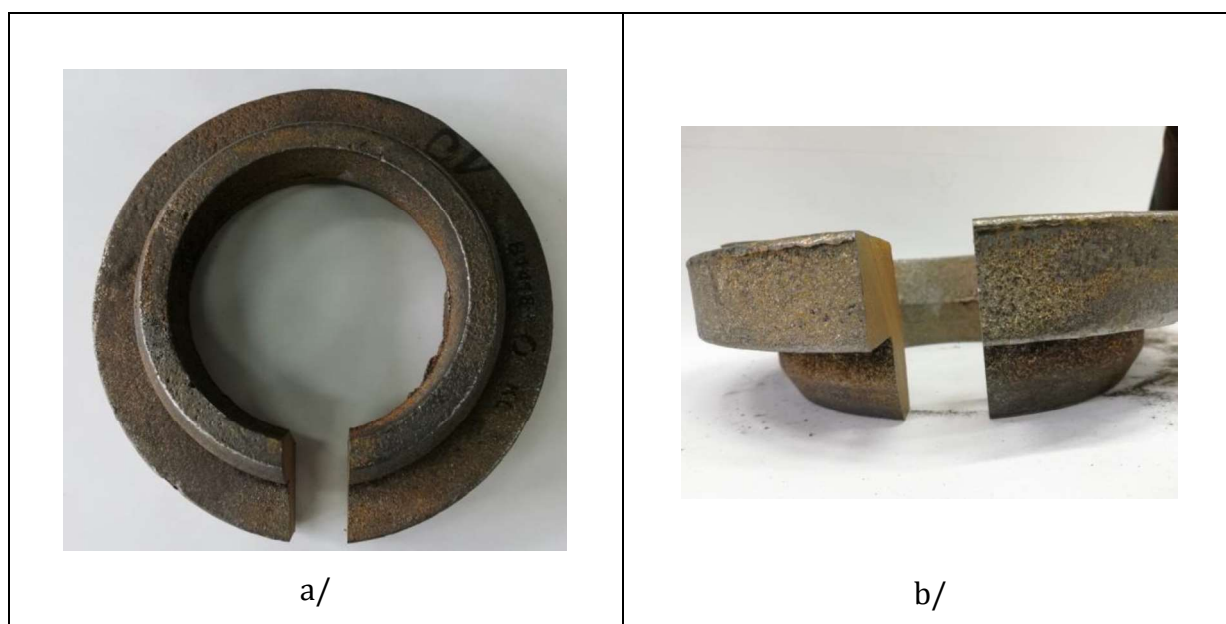
Rys. 3.12. Odlew próbny wykonany w technologii z podwójną rafinacją z zaznaczeniem miejsca pobierania próbek do badań udarności, żeliwo EN GJS 400-18 - LT.
