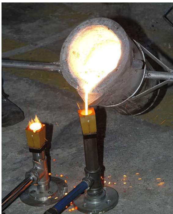
Rys.1.14.Zalewanie próbników do analizy termicznej (ATD)
