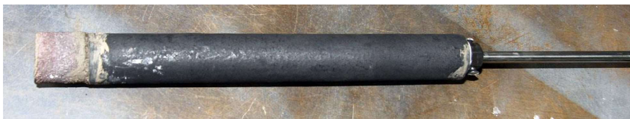
Rys. 1.3. Końcówka lancy z gazo przepuszczalną wkładką umieszczoną na jej końcu.
