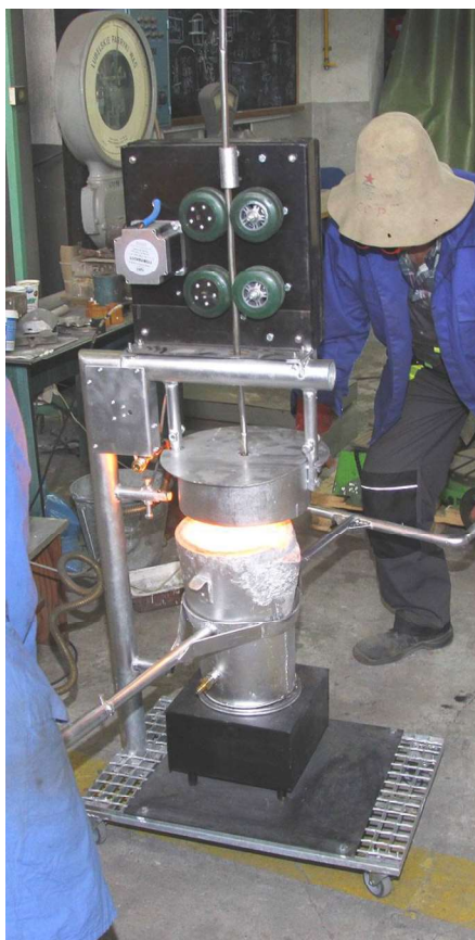
Rys. 1.11. Umieszczanie kadzi z ciekłym żeliwem na mobilnym stanowisku do sferoidyzacji żeliwa metodą PE z układem dozowania gazu rafinującego
