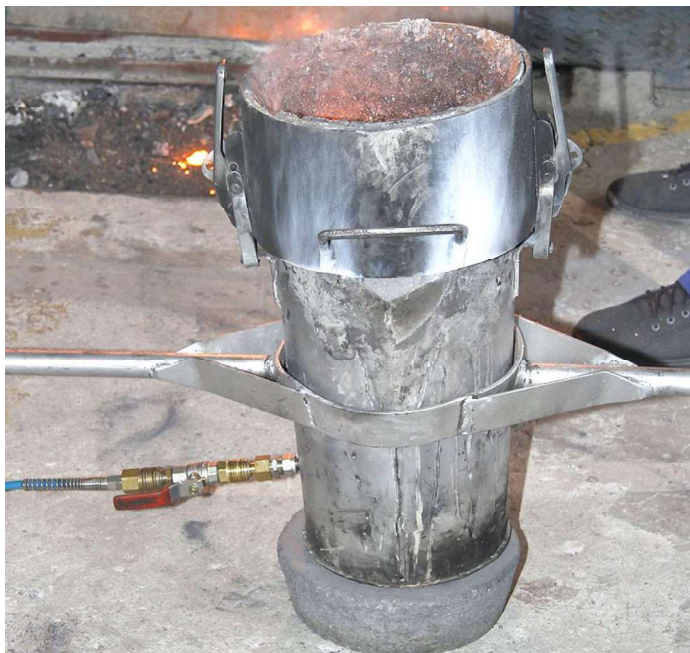
Rys. 1.7. Doświadczalna kadź typu Tundish po sferoidyzacji, w trakcie przygotowania do rafinacji żeliwa (podłączony układ dozowania gazu)
