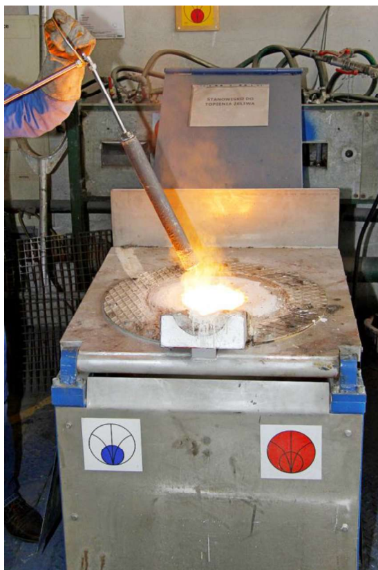
Rys.1.1. Piec indukcyjny Średniej częstotliwości przygotowany do wytopów żeliwa wysokojakościowego (przygotowanie lancy do rafinacji żeliwa)
