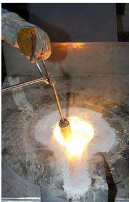
Rys. 1.13. Rafinacja żeliwa w piecu laboratoryjnym indukcyjnym o pojemności 35kg
