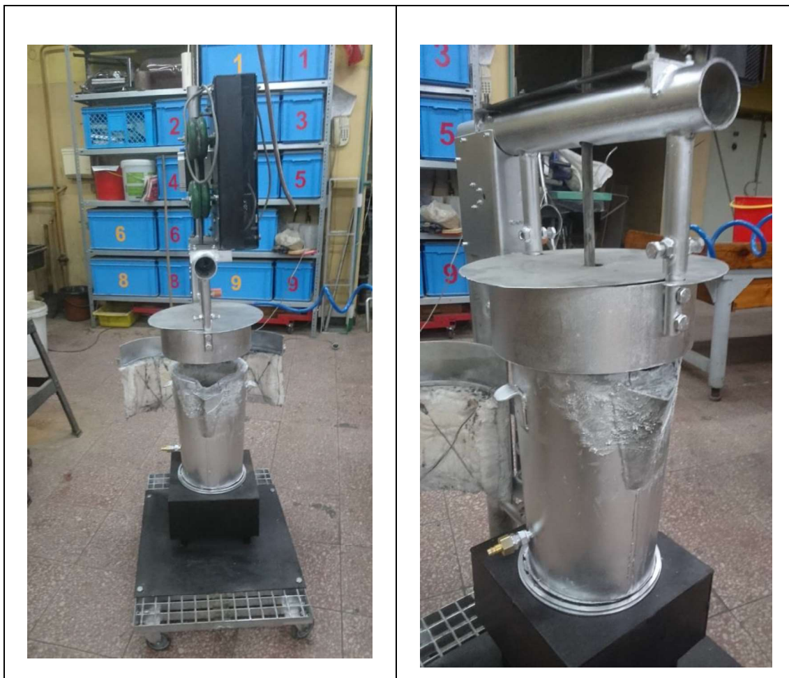
Rys. 1.10. Mobilne stanowisko do sferoidyzacji żeliwa metodą PE z układem dozowania gazu rafinującego przez wkładkę gazo-przepuszczalną umieszczoną w dnie kadzi
