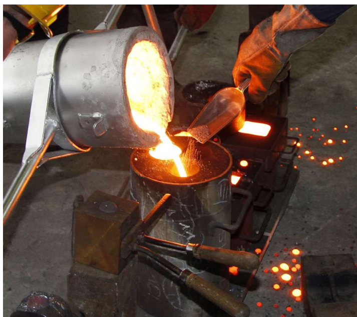
Rys. 1.16. Zalewanie form wałków próbnych z modyfikacją „na strugę”.
