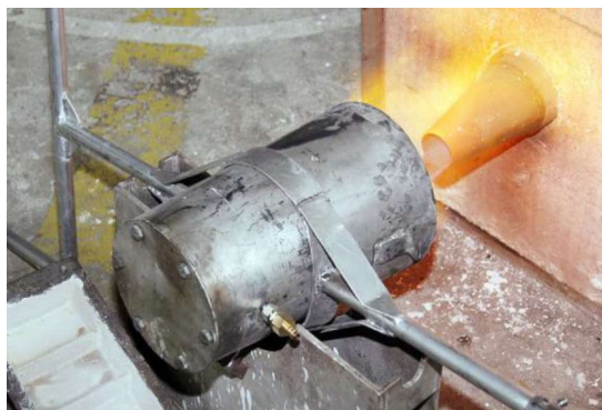
Rys. 1.12. Nagrzewanie kadzi palnikiem gazowym na stanowisku do wygrzewania doświadczalnych kadzi odlewniczych
