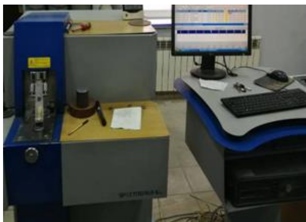
Rys. 5.1. Laboratorium badań składu chemicznego żeliwa wyposażone w spektrometr emisyjny typu „SPEKTROMAX”.
