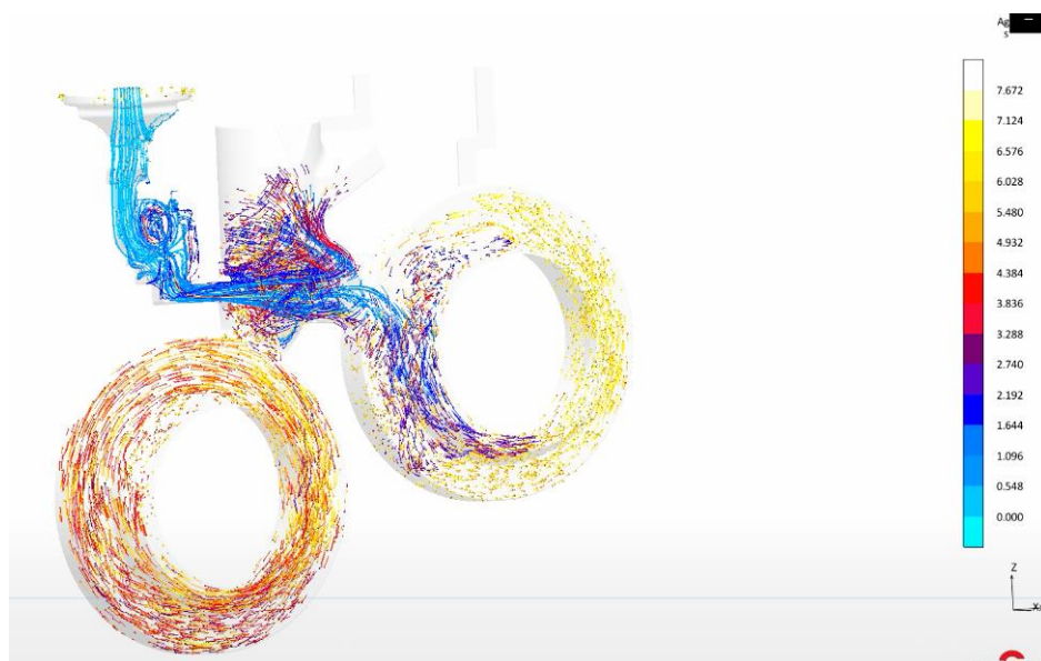
Rys 3.7. Odlew WT-2. Wyniki symulacji - znaczniki przepływu dla poszczególnych faz wypełniania wnętrza formy
