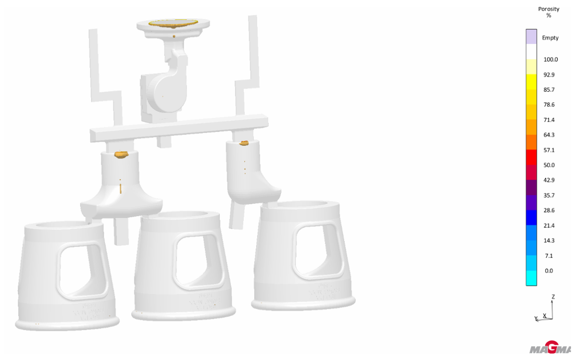
Rys 3.5. Odlew WT-1. Wyniki symulacji – prognoza porowatości
