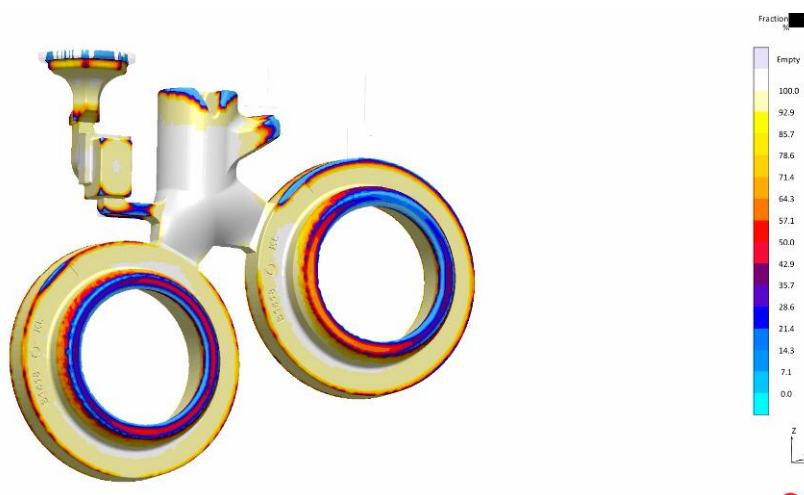
Rys 3.9. Odlew WT-2. Wyniki symulacji - temperatura żeliwa dla poszczególnych faz wypełniania wnętrza formy
