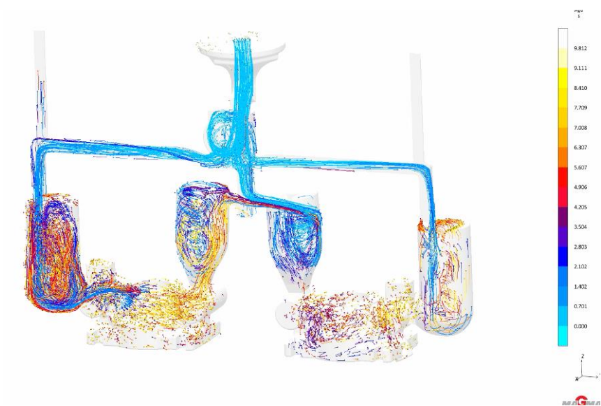
Rys 3.13. Odlew WT-3. Wyniki symulacji - znaczniki przepływu dla poszczególnych faz wypełniania wnętrza formy
