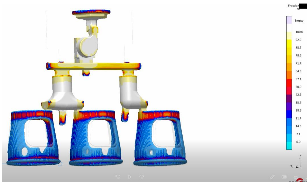
Rys 3.3. Odlew WT-1. Wyniki symulacji - temperatura żeliwa dla poszczególnych faz wypełniania wnętrza formy
