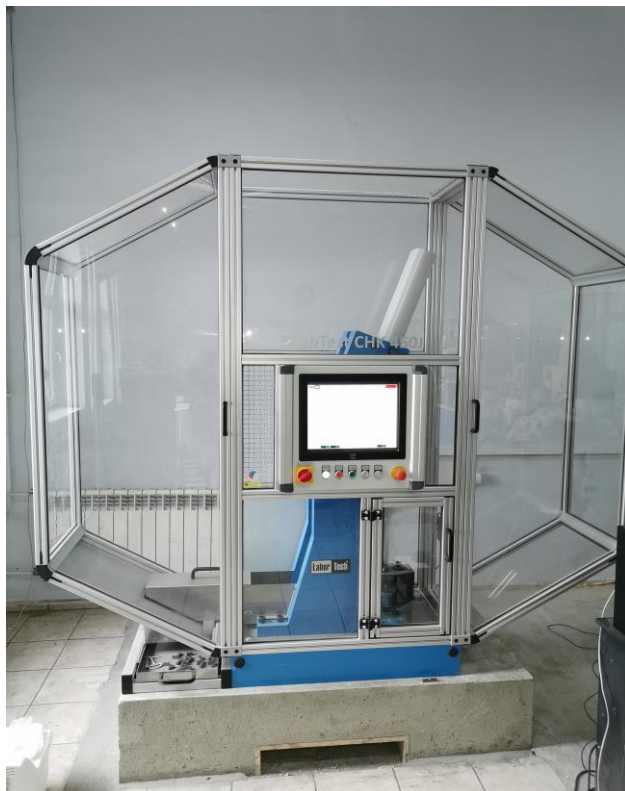
Rys. 6.3. Młot Charpygo 450J do badania udarności.
