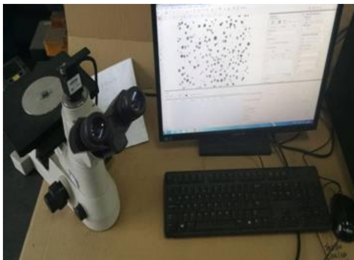
Rys.6.1. Mikroskop do badań metalograficznych MA100.
