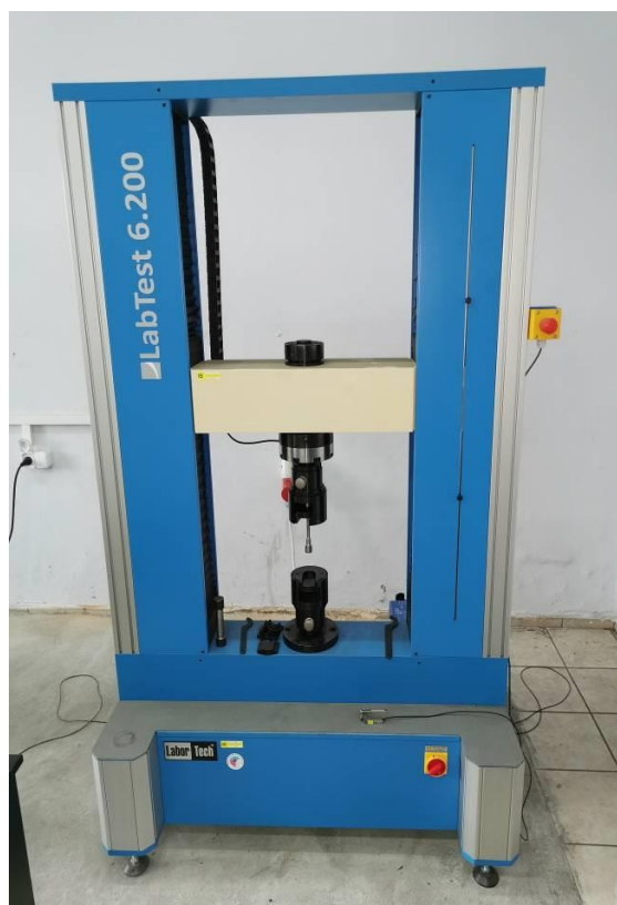
Rys 6.2. Maszyna wytrzymałościowa LabTest 6.200.1.10.
