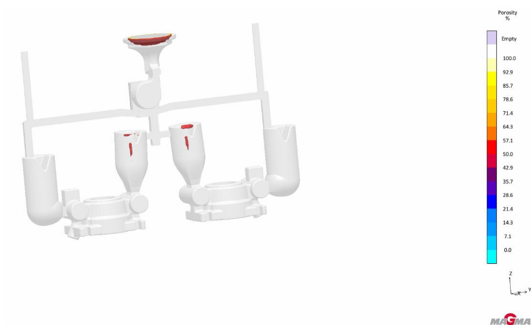
Rys 3.17. Odlew WT-3. Wyniki symulacji – prognoza porowatości
