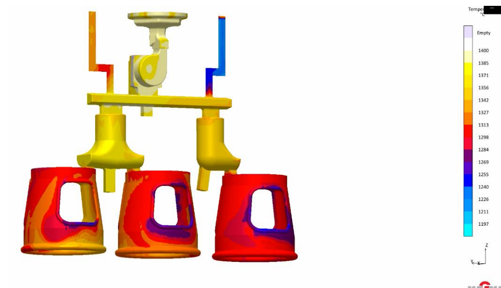
Rys 3.3. Odlew WT-1. Wyniki symulacji - temperatura żeliwa dla poszczególnych faz wypełniania wnętrza formy
