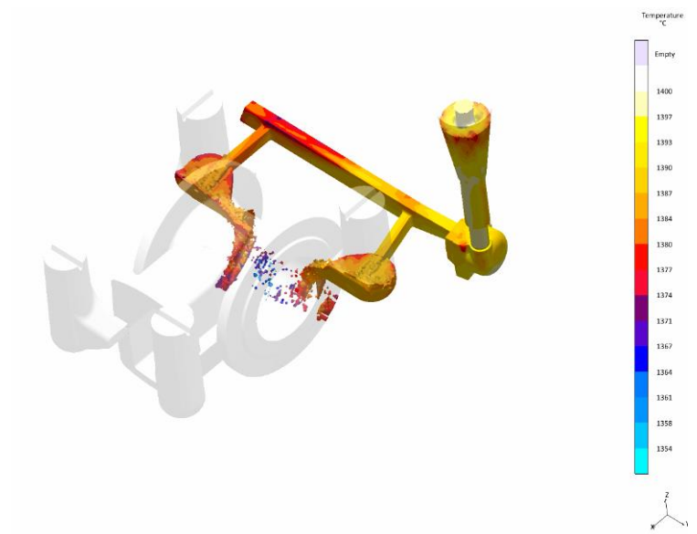
Rys 3.38. Odlew WT-7. Wyniki symulacji - prędkość żeliwa dla poszczególnych faz wypełniania wnęki formy
