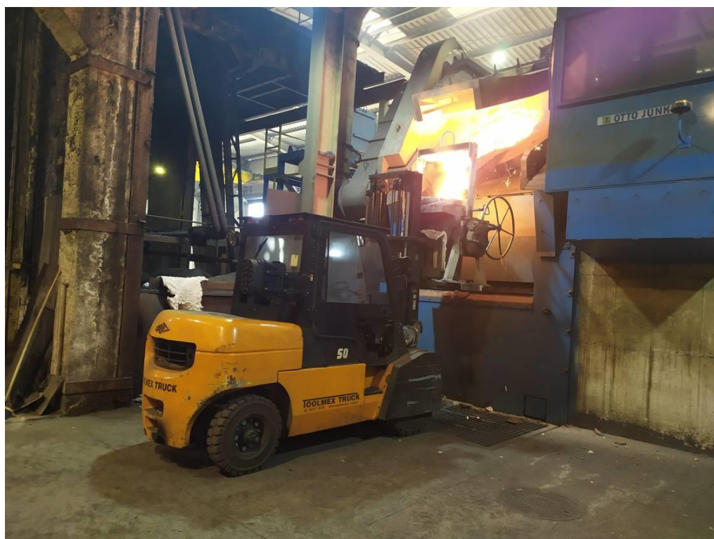
Rys.4.3. Przelewanie żeliwa wyjściowego z pieca do kadzi smukłej.
