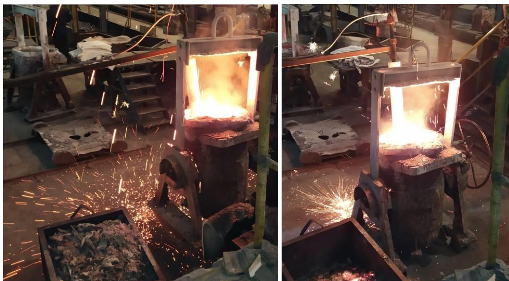
Rys. 2.17. Rafinacja w kadzi zabiegowej przy użyciu lancy - przepływu gazu 5 i 3,5 [l/min]
