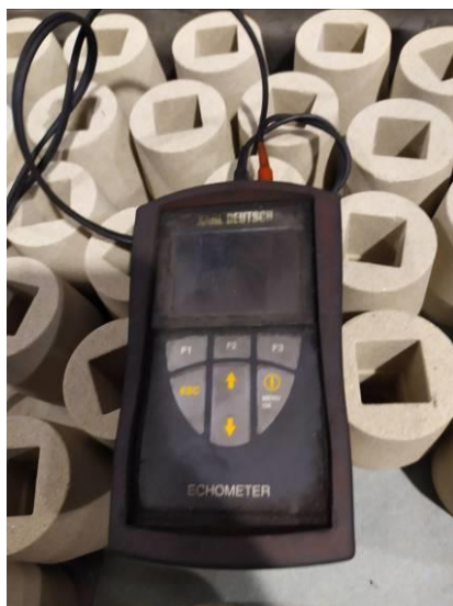
Rys. 5.16. Zestaw pomiarowy stosowany w ocenie stopnia sferoidyzacji żeliwa
