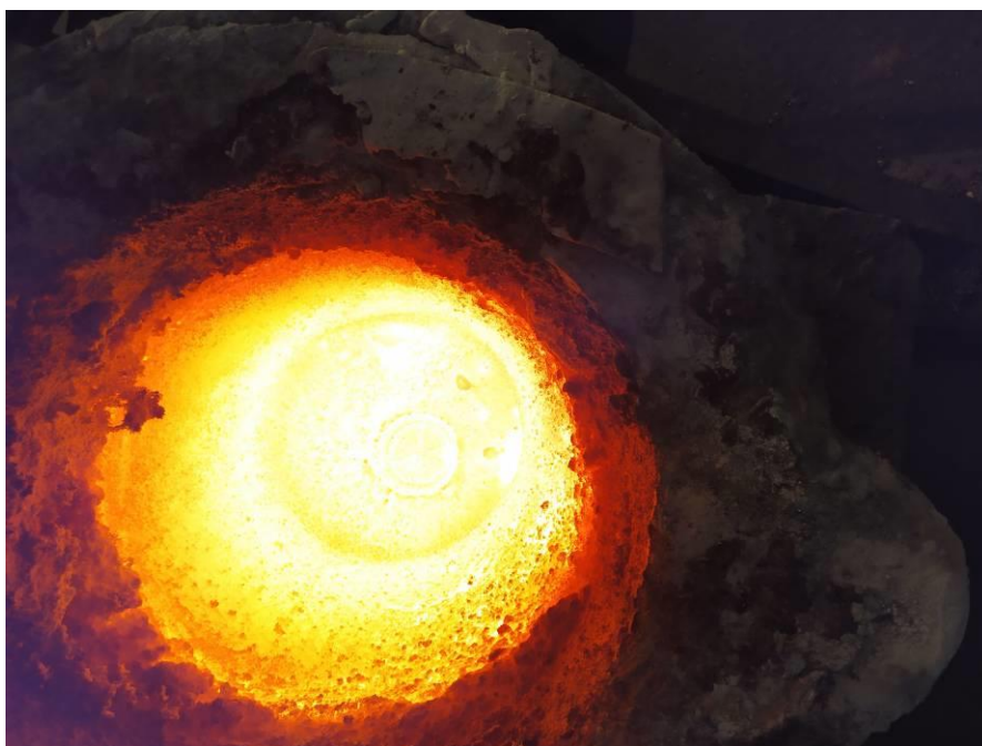
Rys. 5.11. Kadź w zamontowaną wkładkę gazoprzepuszczalną.
