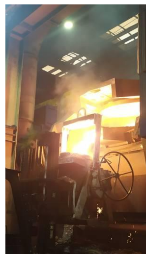
Rys. 2.6. Przelanie części wytopionego żeliwa do kadzi zabiegowej
