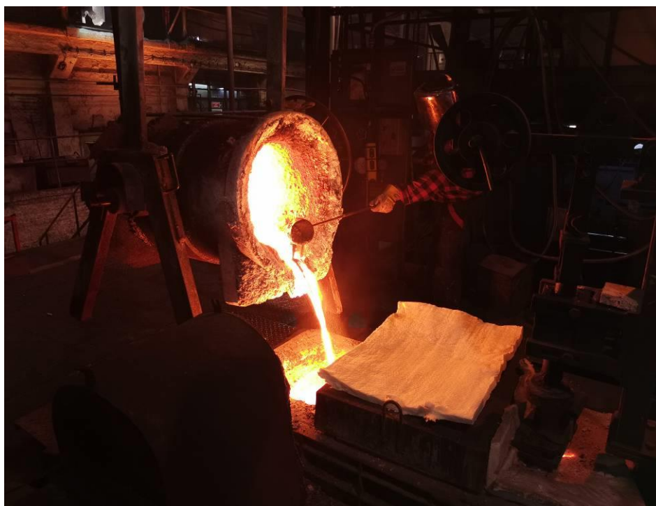
Rys.1.8. Modyfikacja żeliwa w trakcie przelewania metalu do zalewarki.
