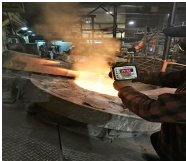
Rys. 5.1. Pomiar temperatury żeliwa w piecu przy użyciu Digilancy.
