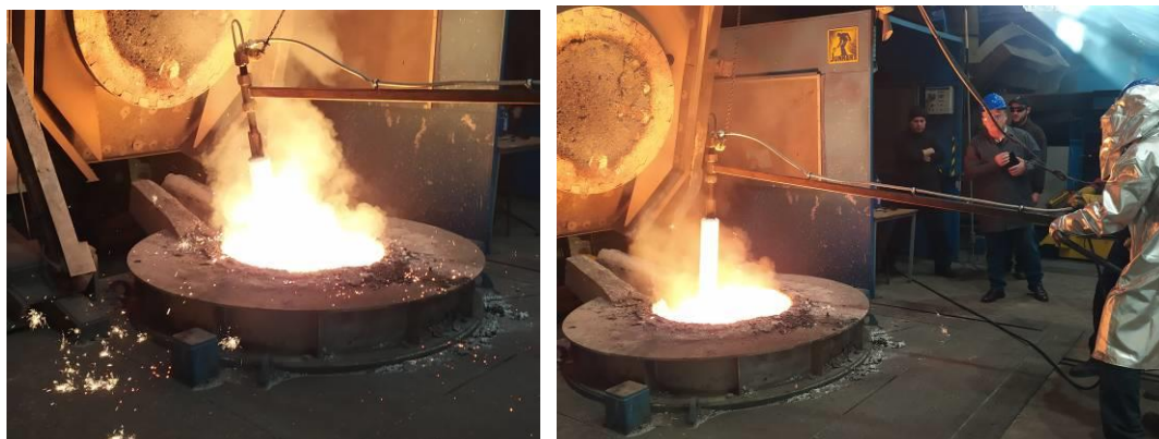
Rys. 2.16. Rafinacja w piecu przy użyciu lancy (czas 2 [min]., 5 [l/min], 2,0 [bar])
