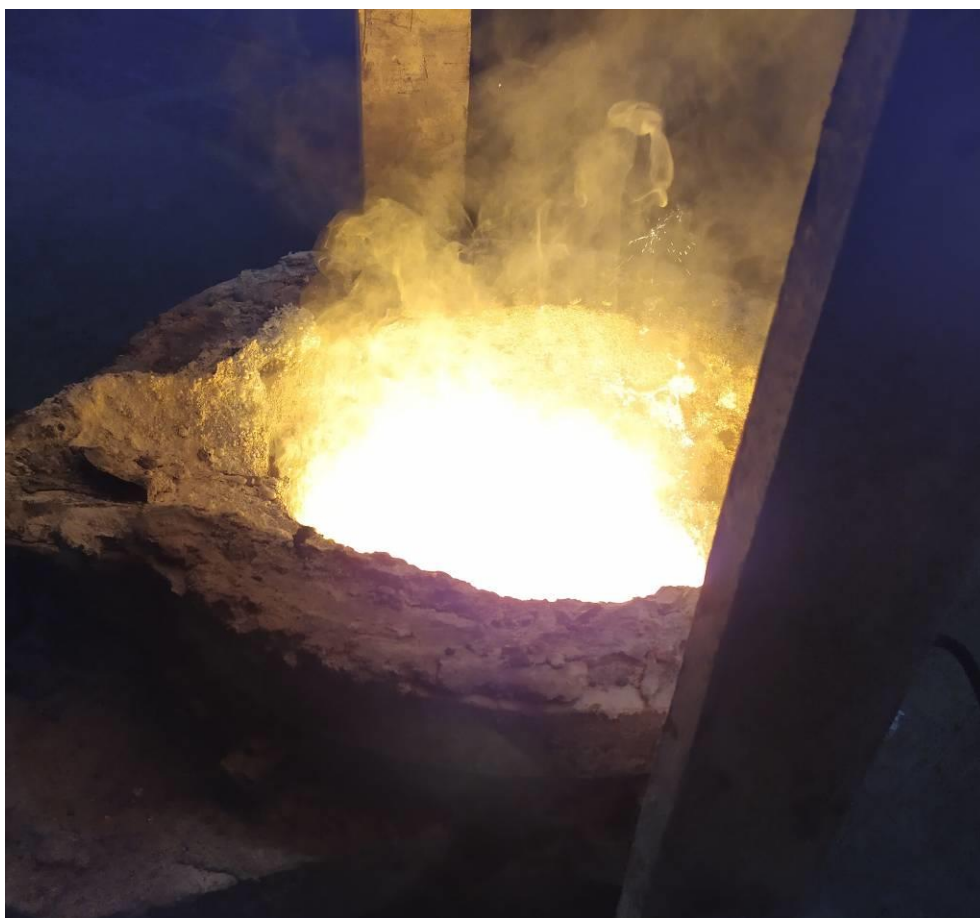
Rys. 5.12. Proces rafinacji w kadzi z wkładką gazoprzepuszczalną
