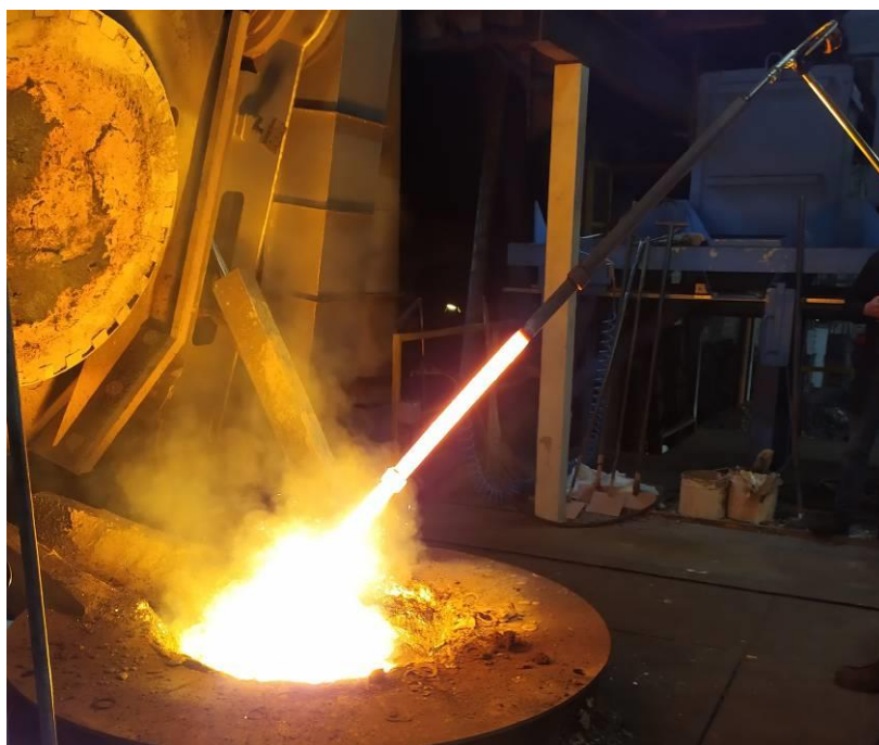
Rys. 2.10. Lancy po zakończonym procesie rafinacji w piecu
