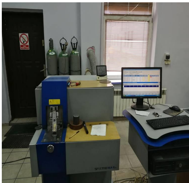
Rys. 1.10. Laboratorium badań składu chemicznego żeliwa wyposażone w spektrometr emisyjny typu „SPEKTROMAX”.
