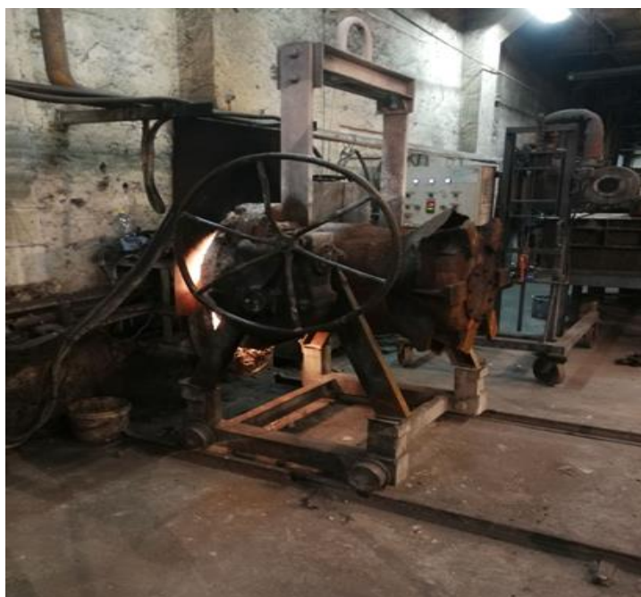
Rys. 1.4. Stanowisko wygrzewania kadzi smukłych do sferoidyzacji żeliwa.
