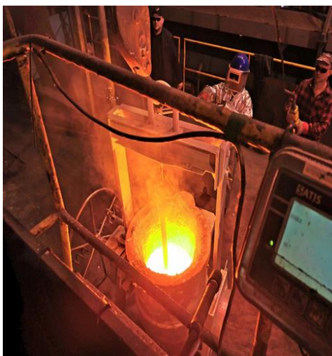
Rys.1.6. Stanowisko do rafinacji żeliwa w kadzi smukłej za pomocą lancy z głowicą grafitową.
