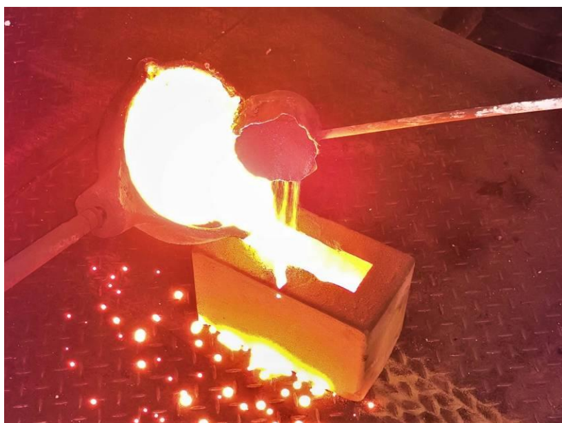
Rys.4.9. Modyfikacja żeliwa podczas zalewania próby kontrolnej YII. Trzeci stopień modyfikacji.
