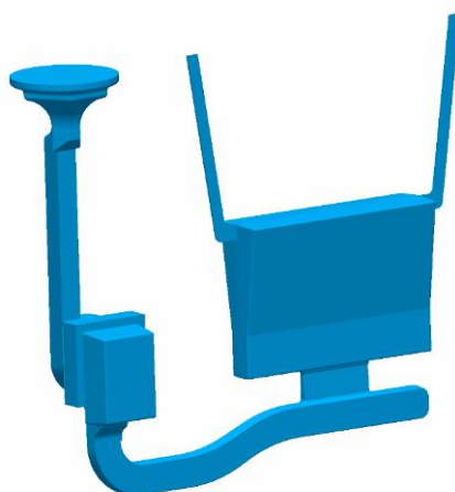
Rys 7.13. Model bryłowy odlewu z układem wlewowym wersja V6
