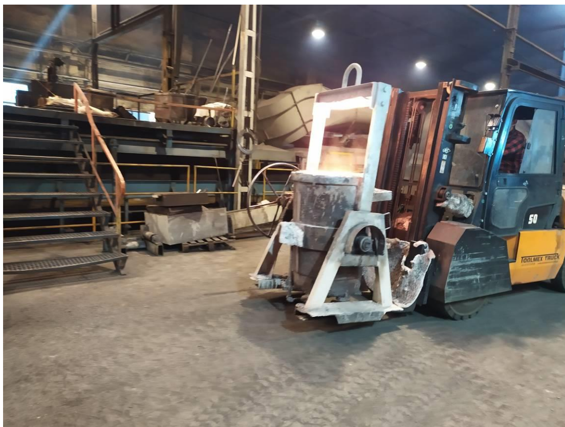
Rys.4.4. Transport żeliwa na stanowisko zabiegu sferoidyzacji.
