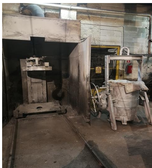
Rys. 2.7. Zmechanizowane stanowisko do sferoidyzacji metodą przewodu elastycznego PE.
