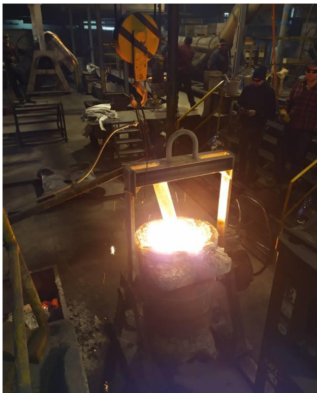
Rys. 5.10. Rafinacja w kadzi – umieszczanie lancy w kadzi.
