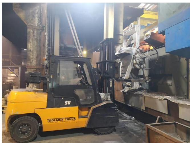
Rys. 2.6. Przelanie części wytopionego żeliwa do kadzi zabiegowej
