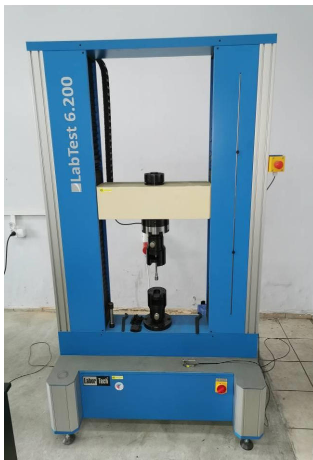
Rys 1.12. Maszyna wytrzymałościowa LabTest 6.200.1.10.
