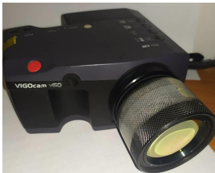
Rys. 5.2. Kamera termowizyjna VIGOcam V50
