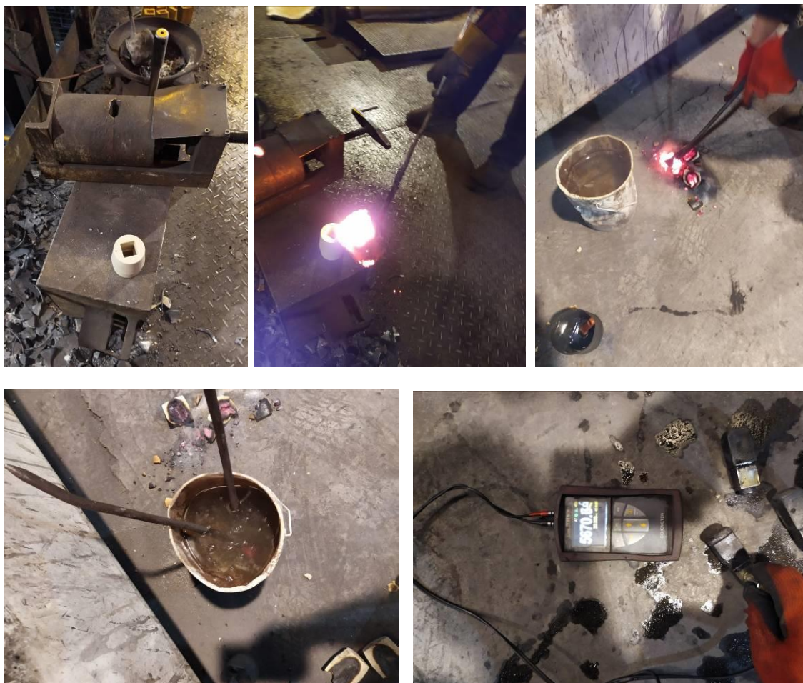
Rys. 5.19. Proces przygotowania próbki i pomiar na stanowisku do kontroli stopnia sferoidyzacji żeliwa
