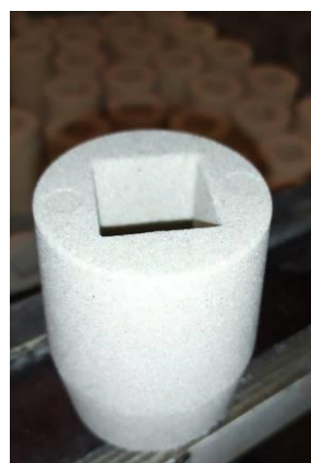
Rys. 5.16. Zestaw pomiarowy stosowany w ocenie stopnia sferoidyzacji żeliwa
