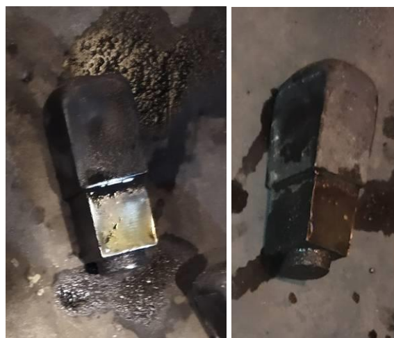
Rys. 5.18. Prostopadłościenna próbka do badania prędkości fali
