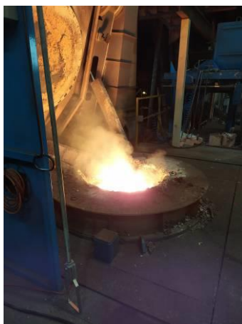
Rys. 2.3. Piec indukcyjny o pojemności 6000 kg.
