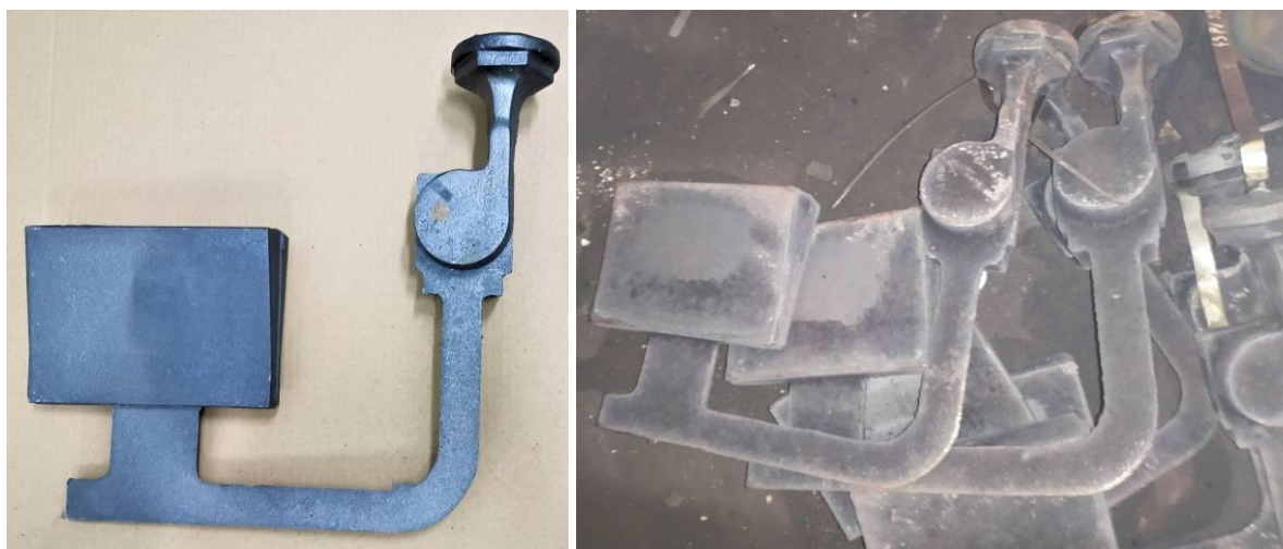
Rys. 7.17. Eksperyment odlewania - odlew Y2 uzyskany w formie z pionową powierzchnią podziału
