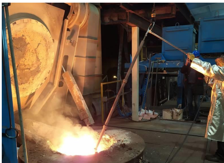
Rys. 2.9. Rafinacja w piecu przy użyciu lancy (czas 2 [min]., 5 [l/min], 2,0 [bar])
