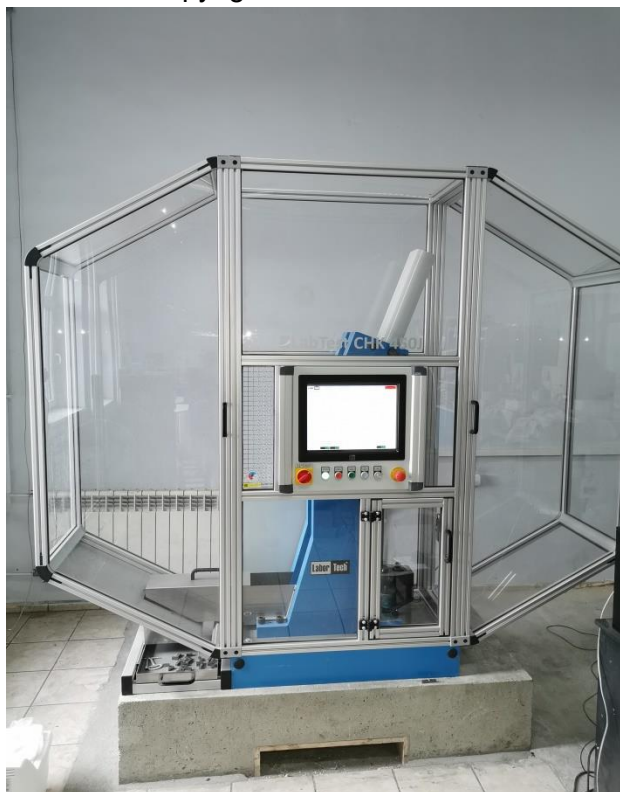
Rys. 6.1. Młot Charpyego 450J do badania udarowości.
