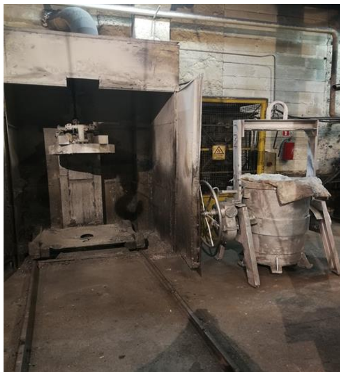
Rys. 1.5. Zmechanizowane stanowisko do sferoidyzacji metodą przewodu elastycznego PE.
