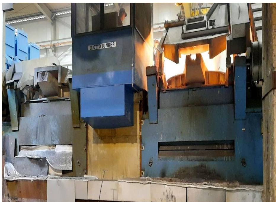
Rys. 4.2. Piece indukcyjne średniej częstotliwości o pojemności 6 ton.
