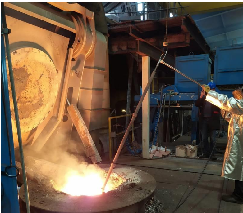
Rys. 2.5. Rafinacja w piecu przy użyciu lancy
