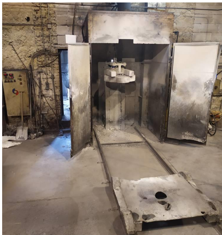
Rys. 4.5. Stanowisko sferoidyzacji metodą przewodu elastycznego (PE)
