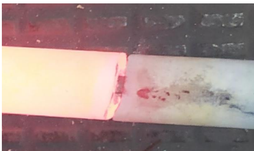
Rys. 2.11. Uszkodzenie lancy po procesie rafinacji w piecu
